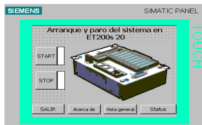
Fig. 9. Ventana del estado del esclavo ET200s para el actuador giratorio
