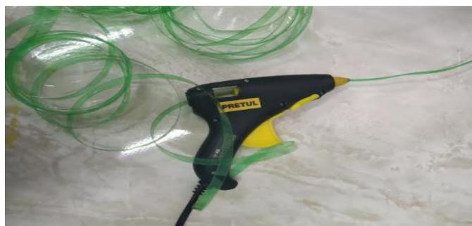
Ilustración 13. Paso 3. Pasar las tiras de PET por una pistola de silicón para formar el filamento
