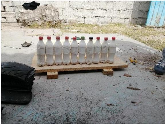
Fig. 3. Se realiza el llenado y el compactado del polvo del mármol en el interior de las botellas PET. Fuente: Fotografía tomada por el equipo de trabajo.
