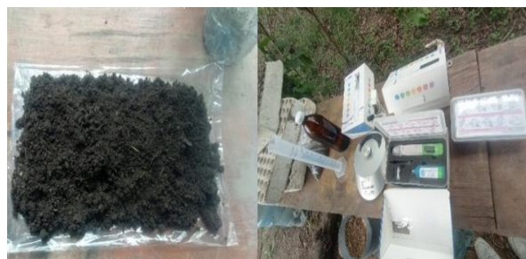
Figura 2: Análisis físico-químicos del sustrato, utilizando un kit edafológico.
