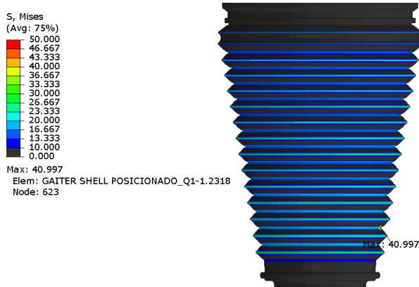
Fig. 11. Distribución de esfuerzos para la mezcla POE/PP 70-30. (Elaboración Propia, 2026.)
