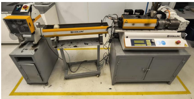
Fig. 1 Extrusora de doble husillo corrotante marca Collin usada para mezclar el material. (Elaboración Propia, 2026.)
