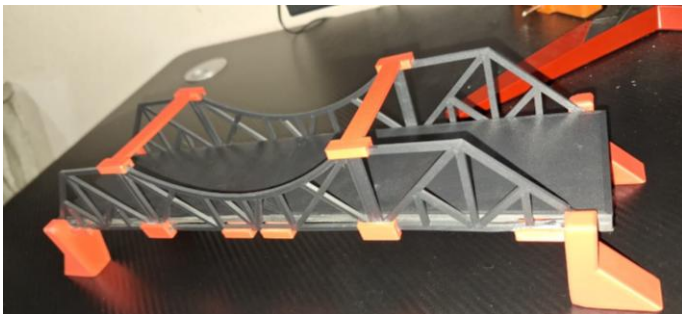
Fig. 13. Prototipo ensamblado del puente Baltimore fabricado en ABS (vista detallada).
