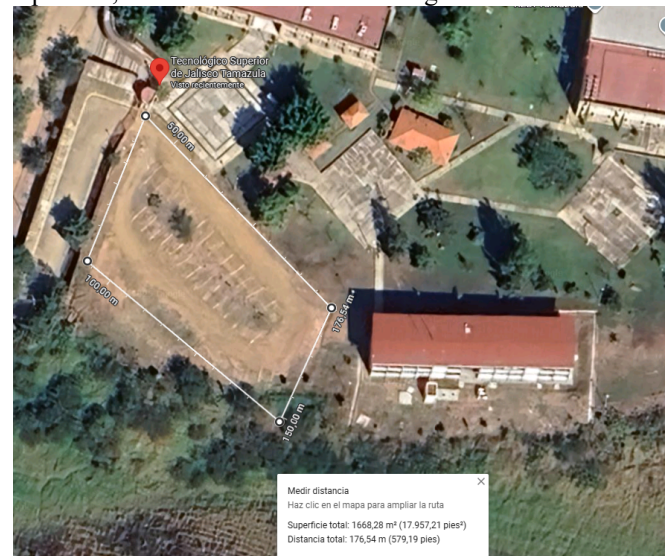
Figura 1. Delimitación y medición del área del estacionamiento del Instituto Tecnológico Superior de Jalisco, Unidad Académica Tamazula, obtenida mediante Google Earth Pro. Se observa una superficie aproximada de 1,669 m 2 delimitada para el análisis y diseño del sistema fotovoltaico carport.
