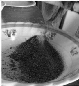
**Fig. 7.** Proceso de molido de la cascarilla.
