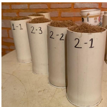
Figura 2. Porómetros usados para el experimento con los sustratos evaluados.
