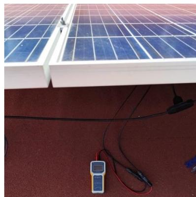
Figura 12 Validación de resultados para módulo 1 con el uso del dispositivo Elejoy E1600W. Fuente: Elaboración propia.
