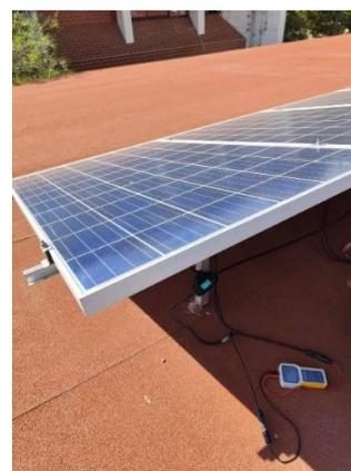
Figura 13 Validación de resultados para módulo 2 con el uso del dispositivo Elejoy E1600W. Fuente: Elaboración propia.
