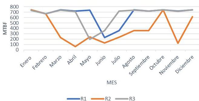
Fig. 5. Comparación de Tiempo Medio Entre Fallas de las cámaras de refrigeración R1, R2 y R3 en 2023.
