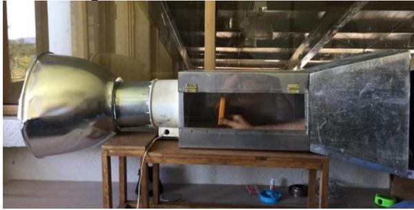
Fig. 13. Túnel del viento construido
