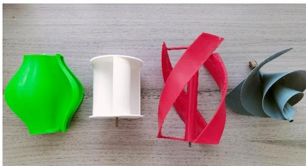
Fig. 8. Turbinas elaboradas mediante tecnología FDM, de derecha a izquierda, Savonius (modelo 1), Savonius (modelo 2), Darrieus y LIAM F1 UWT.
