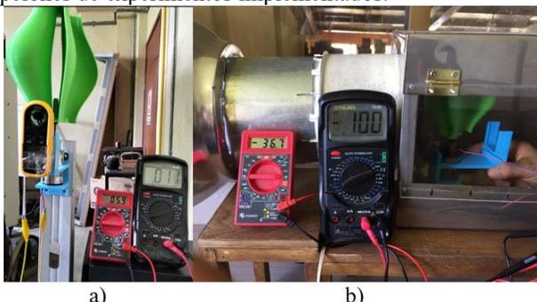
Fig. 15. Experimentos aplicados a turbina Savonius a) flujo de viento dirigido; b) flujo de viento a través de túnel del viento
