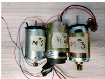
Fig. 9. Generadores de corriente directa seleccionados
