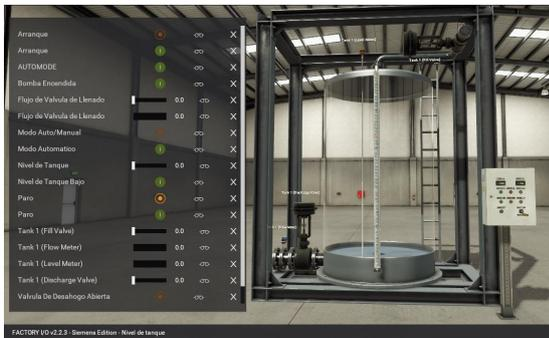
Fig. 5. Escenario para el control de nivel en Factory IO.
