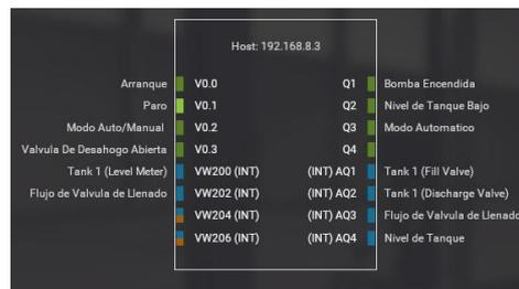
Fig. 8. Enlace de variables del PLC en Factory IO.
