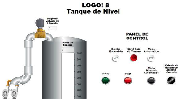
Fig. 13. HMI implementada para la supervisión del tanque con Web Editor.
