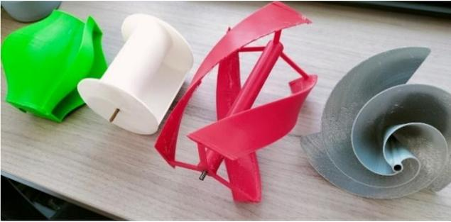
Fig. 18. De derecha a izquierda se muestran las turbinas: Savonius (modelo 1), Savonius (modelo 2), Darrieus y tipo horizontal, elaboradas con manufactura aditiva.
