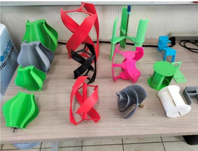
Fig. 19. Variedad de turbinas con diferentes dimensiones, elaboradas con manufactura aditiva.
