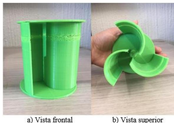
Fig. 15. Turbina Savonius (modelo 2), elaborada con manufactura aditiva.
