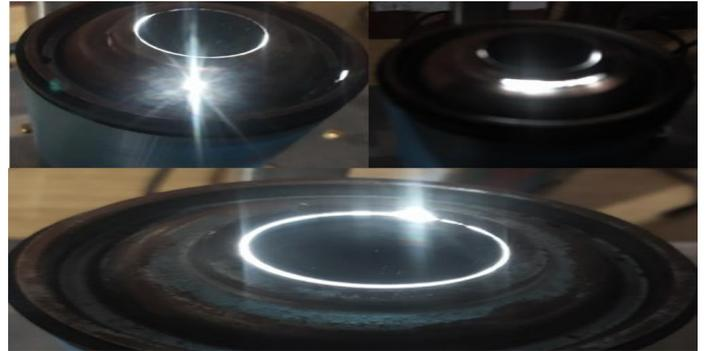
Fig. 18. Sellos con defectos expuestos a la luz.
