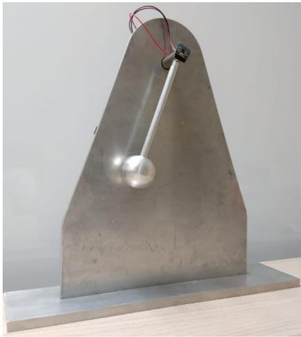
Fig. 8. Prototipo experimental del Sistema mecánico péndulo físico.
