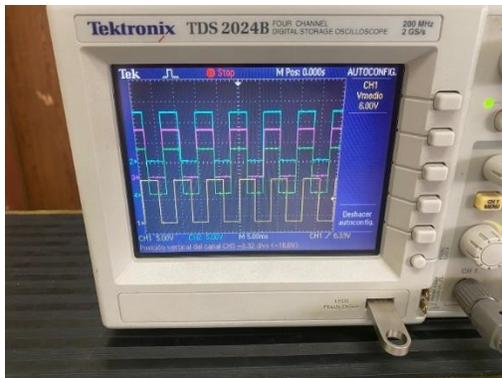
Fig. 8: Captura de las señales de movimiento de los motores a pasos en el osciloscopio.
