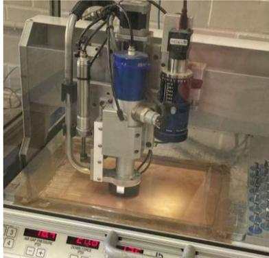
Fig. 5: Maquilado de PCB en CNC T-Tech.
