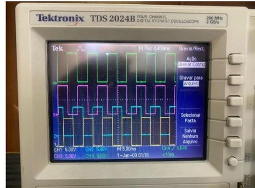
Fig. 9: Captura de las secuencias de los motores a pasos en el osciloscopio.
