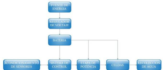
Figura 5 Descripción de bloques de funcionamiento
