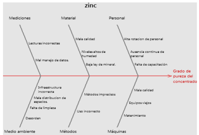
Gráfico 4 Diagrama Causa-Efecto para el análisis del grado de pureza del concentrado de zinc Fuente: Elaboración propia
