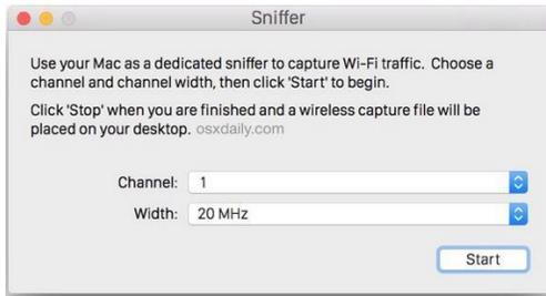
Fig. 11 Herramienta Sniffer dentro de Wireless Diagnostic (MacOS).
